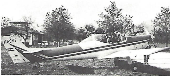
LIBIS 180 ist die neueste Ausführung der KB-6 mit Lycoming Boxermotor in Lesce - Bled.
