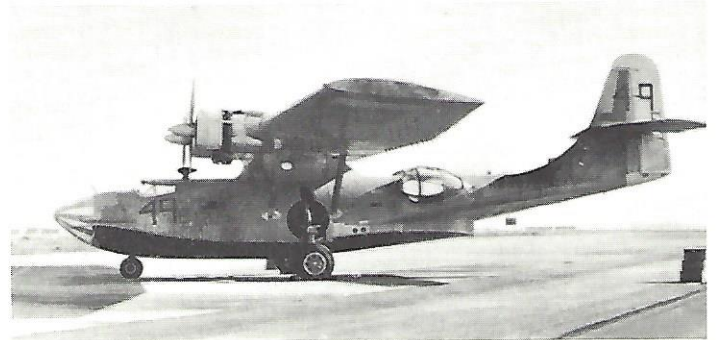
PBY-6A Wasserbomber des Sonora Flying Service, Columbia/Calif., man beachte das Fehlen der Stüttschwimmer. (Abmontiert, da nur vom Land aus operiert)
