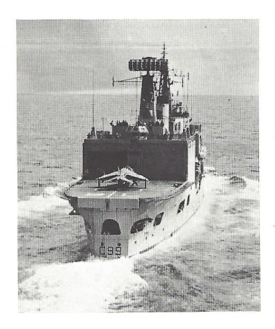
Mit der Harrier wurden eine Anzahl Starts und Landungen auf dem Kreuzer H.M.S. Blake durchgeführt. Es handelte sich um Versuche des britischen Verteidigungsministeriums für schiffsgestützte Einsätze der Harrier ab Mitte der siebziger Jahre. Während den 34 Starts und Landunggen auf dem 40 x 9 Meter grossen Flugdeck hatte die Blake lo bis 25 Knoten Fahrt und rollte bis 5 Grad.
