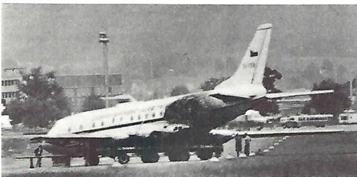
Die TU-124 der CSA ein Tag nach der Bauchlandung Foto: R. Langlotz
